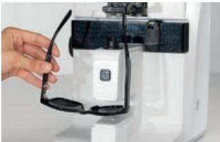
Durch gleichzeitiges Messen der UV-Transmission bei vier verschiedenen Wellenlängen zwischen 365 und 405 nm können Brillengläser auf ihren UV-Schutz untersucht werden.
