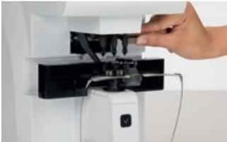
Der ZEISS VISULENS 500 verfügt über eine Glashalterung mit vier Stiften, in die sich Augengläser jeder Art sicher und zuverlässig einlegen lassen. Mit dem präzise angeordneten Stift-System werden der optische Mittelpunkt und die Zylinderachse deutlich markiert.
